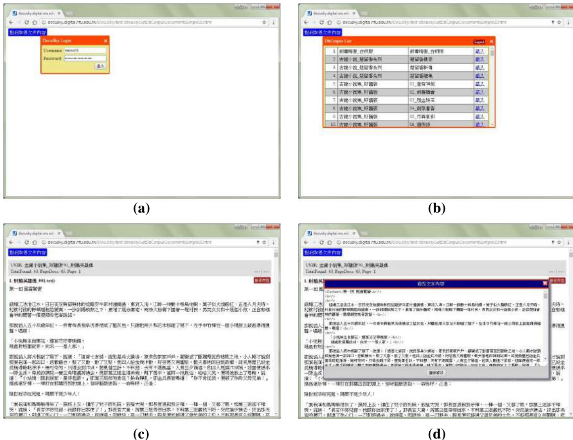
圖 1 DocuSky 所提供的 widget 使用範例網頁。(a)使用者在登入前 widget 會要求以 DocuSky 帳號登入。(b)在使用者登入後，widget 則會列出個人資料庫的文獻集列表。(c)使用者載入選擇的文獻集後，會依照 widget 中的設定，顯示載入的文件內文。(d)widget 亦提供更新文件的功能，讓工具可以修改並上傳文件。
